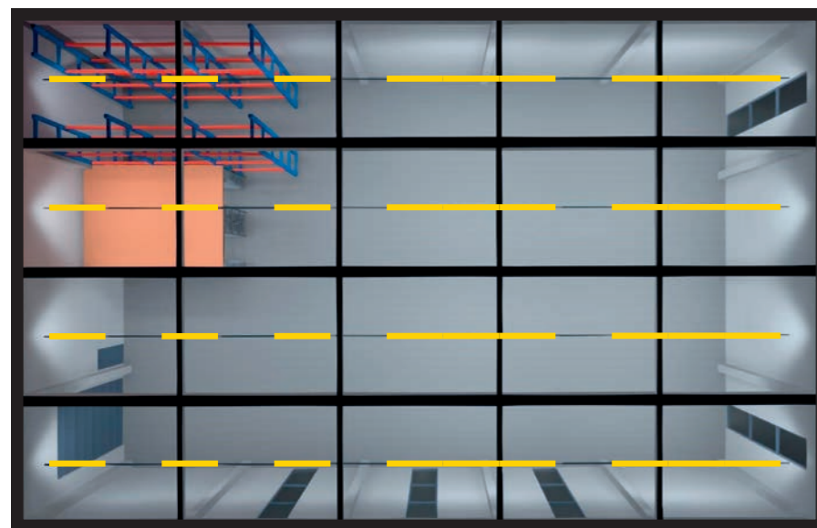
Draufsicht mit Verteilung der Lichtbänder unter der Hallendecke (Montagehöhe: 6,50 m)
